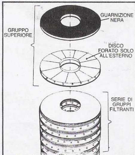
Il disco superiore di tutto il blocco deve essere quello dotato di fori solo sulla circonferenza esterna. Sopra di esso collocate la guarnizione in gomma nera.
